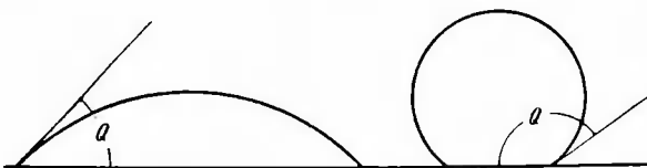
Рис. 2. Краевой угол воды на гидрофильной (слева) и гидрофобной (справа) поверхности
